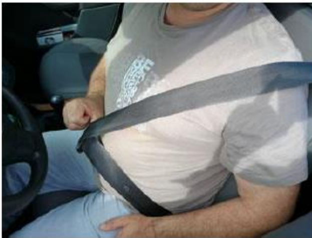
Figure 4. Utilisation correcte de la ceinture de sécurité
