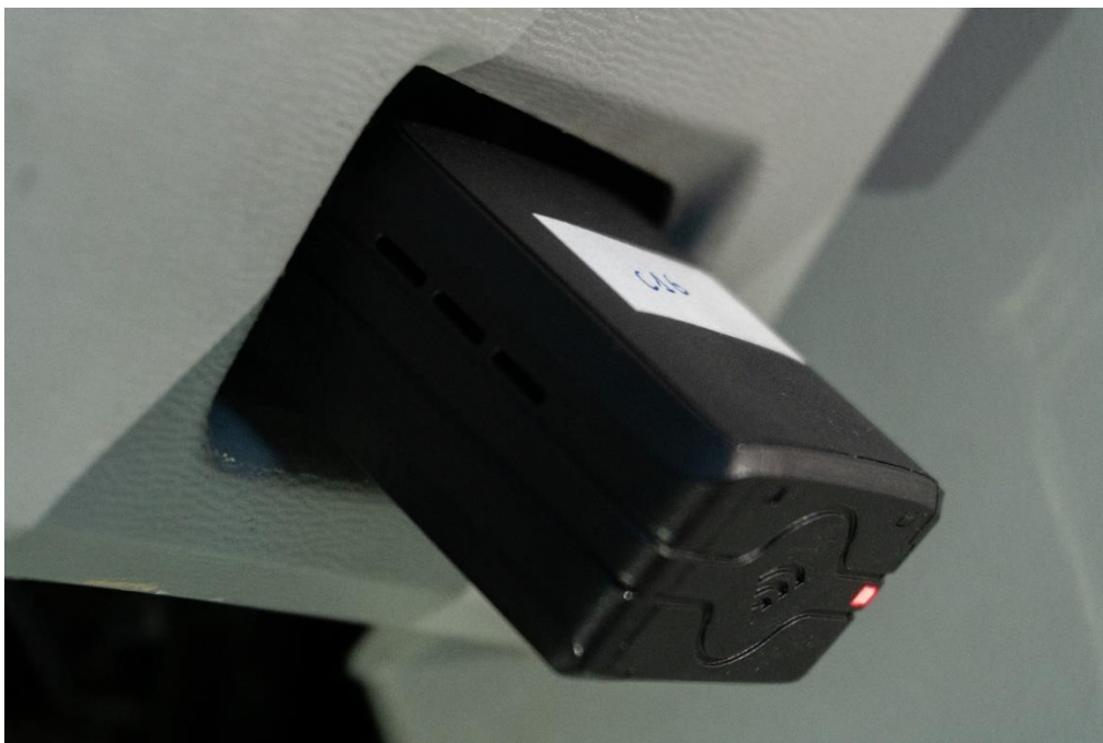
Figure 18 : Boîte noire branchée au port OBD d'une voiture.
