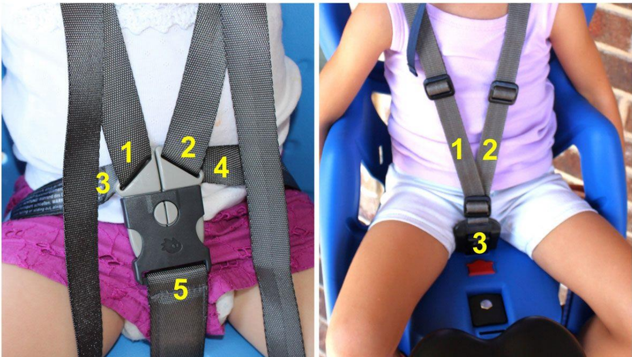
Figuur 8 Vijfpunts gordel (links) en driepunts gordel (rechts)
