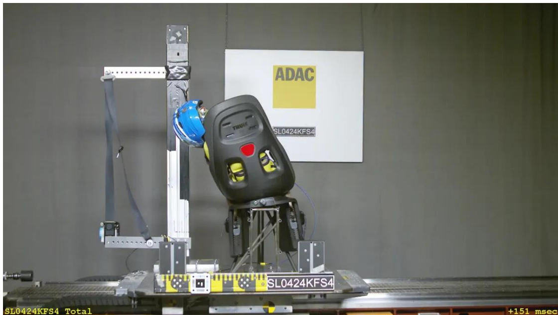
Figure 7 Lors du crash-test avec un siège enfant, la tête du mannequin bascule fortement (rapport ADAC, 2021)©
