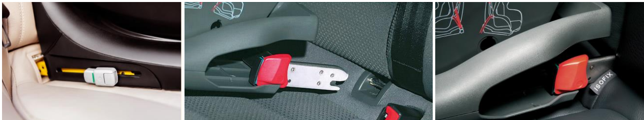
Figure 6. Le système d'ancrage ISOFIX
