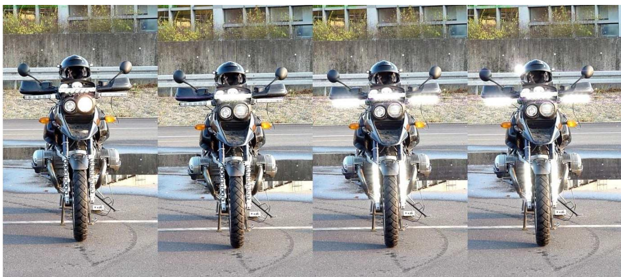
Figure 76: Positions-tests pour l'estimation du taux de visibilité des motos disposant d'un éclairage différent.
