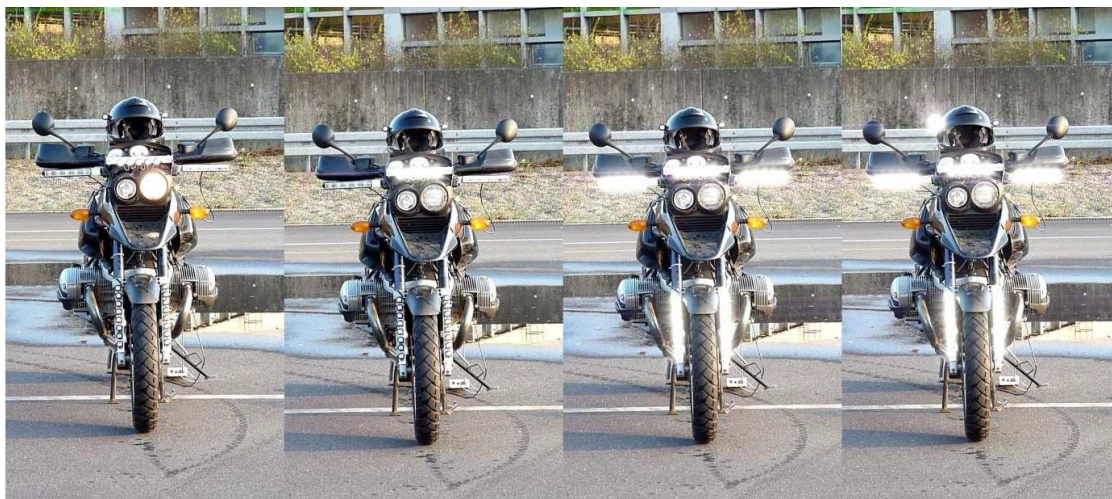
Figuur 76 : Proef-opstellingen voor zichtbaarheidsbeoordelingen van motorfietsen met verschillende verlichtings configuratie.
