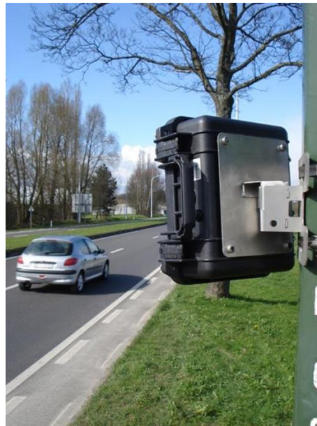
Figure 2 Radars TMS-SA utilisés sur les routes limitées à 30, 50, 70 et 1x1 90 km/h
