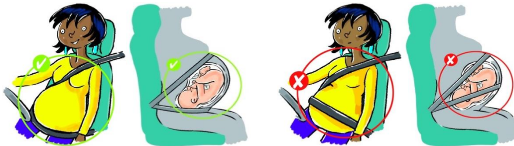
Figure 2: Recommandations pour une bonne utilisation de la ceinture de sécurité pour les femmes enceintes afin de protéger au mieux le fœtus en cas de collision. Source : IBSR, 2014
